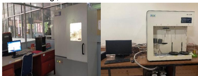
Gambar 5.5 Peralatan SAA dan Porosity (kiri) dan XRD (kanan)
